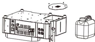
将机器翻转，松开螺丝，取出油瓶挡板；
