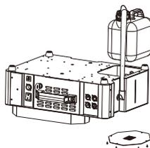
将油瓶挡板安装到另一侧，并且用油瓶锁将油瓶锁住。
